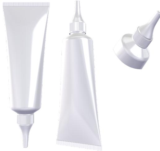
Cet embout s'ouvre par un simple quart de tour. La capsule reste sur le tube et la formule s'écoule par un orifice central. Après l'utilisation du produit, l'utilisateur n'a qu'à tourner la capsule pour le fermer.
